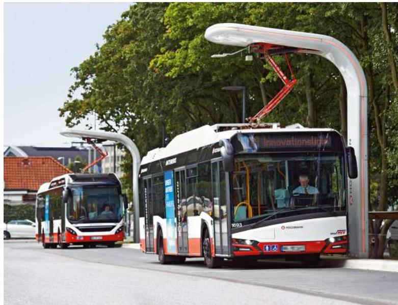
E-Busse bei der Ladung an Pantografen
